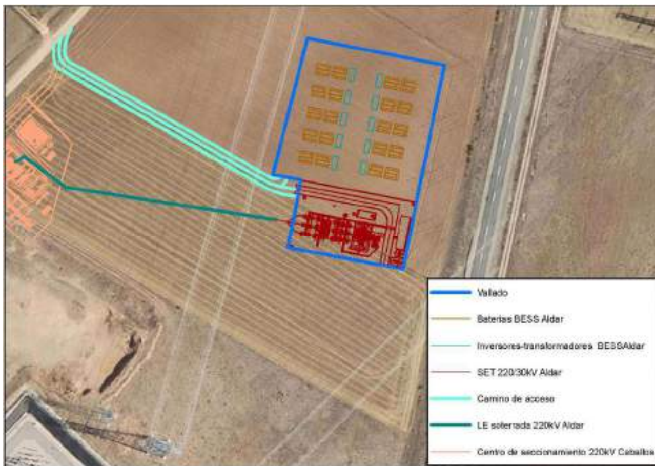
Imagen 10. Detalle infraestructuras BESS
